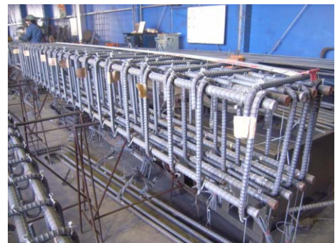
写真1 RC-BS-1 試験体配筋状況
