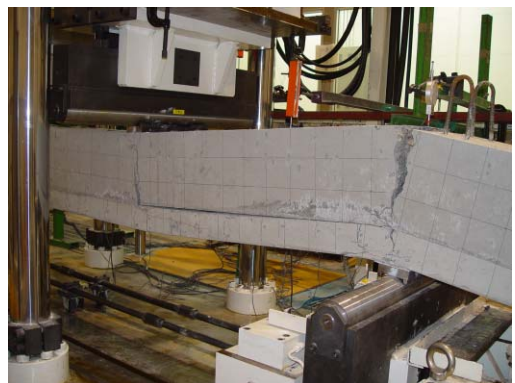
写真6 RC-BS-1 試験体試験終了時
