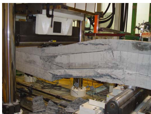
写真5 RC-BS-1 試験体試験終了時
