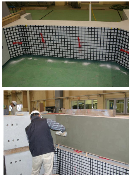
図1 炭素繊維グリッドによる補強方法
