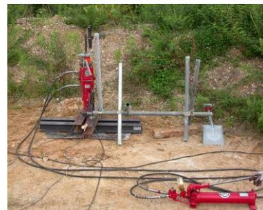
写真-2 補強材引抜試験状況
