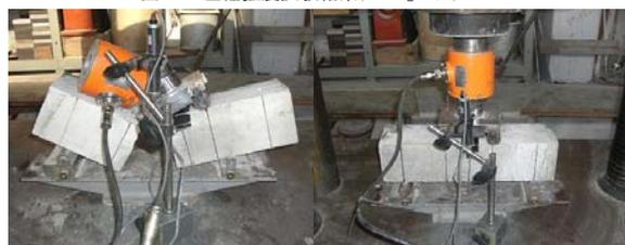
写真1 破壊状況(左:短繊維なし 右:短繊維あり)
