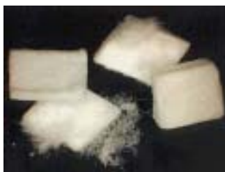
写真1 木材セルロースの繊維写真1 木材セルロースの繊維(長さ約1.9m、径約16ミクロン)のチップ形状
