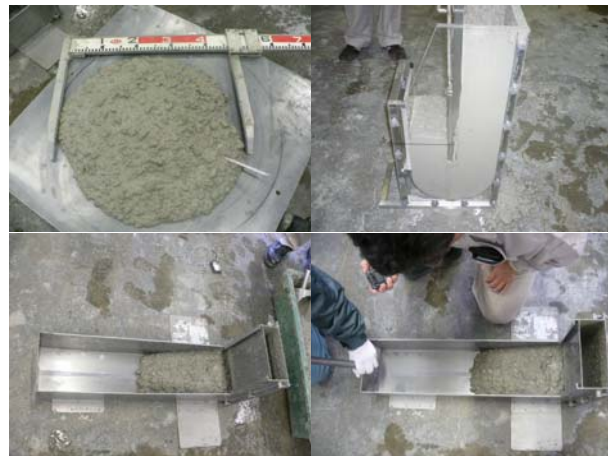
写真-1 フレッシュコンクリートの試験状況
