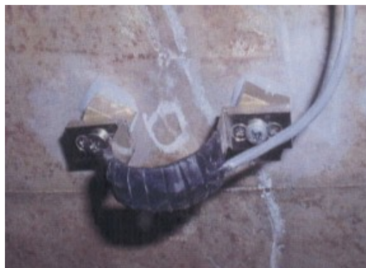
図—1 \pi 型ゲージによる開閉振幅計測
