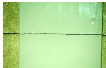
図—4 疲労試験でのひび割れ
