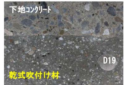
写真3—鉄筋裏面充填状況(上向き)
