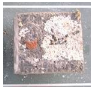
写真-4 No.3 破断状況(5年経過後 H19)
