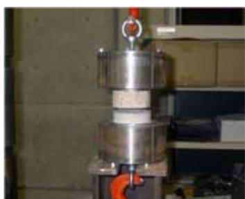
図-1 チャック式直接引張試験治具
