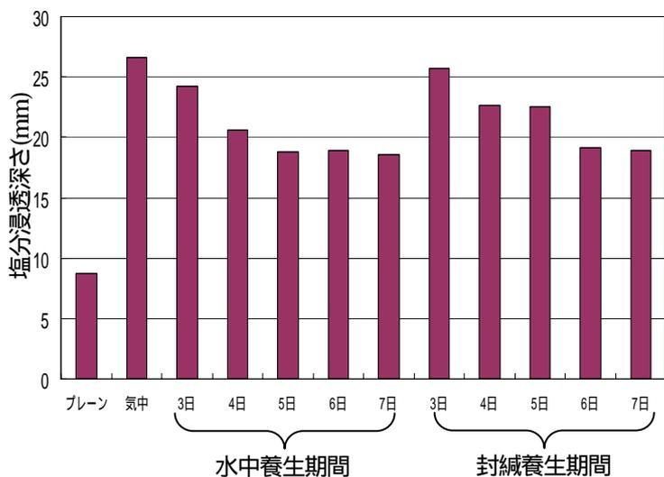
図-3 養生方法・初期養生期間別の塩水浸漬試験結果 (硫酸 K)
