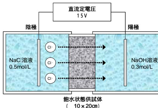
図-3 電気泳動法試験
