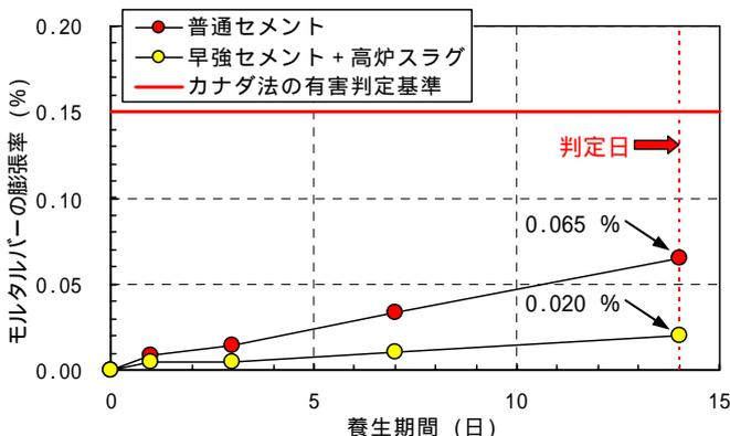
図-1 カナダ法促進モルタルバー法試験結果
