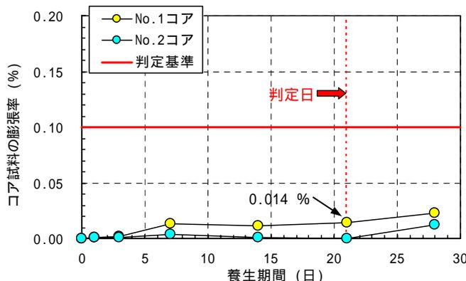
図-2 コンクリートコアのカナダ法促進試験結果
