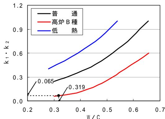
図-5 見掛けの拡散係数への換算係数
