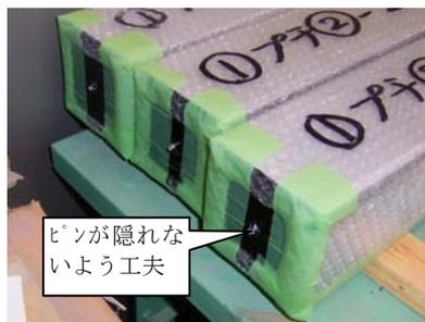
写真-3 長さ変化試験用供試体封緘養生状況
