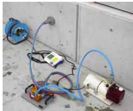
写真-1 透気性試験状況
