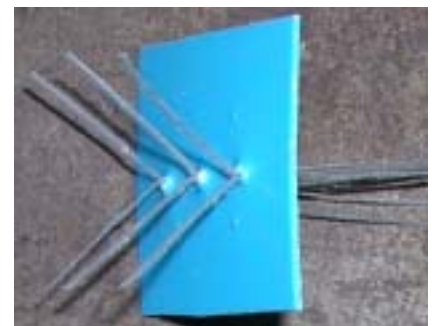
写真-1 繊維埋込み供試体
