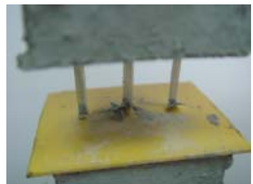
写真 - 3 マトリックスの局部剥落状況 (繊維埋込み角度 75°)
