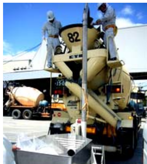
写真-1 繊維投入機によるアジテーターカーへのポリプロピレン短繊維の添加状況
