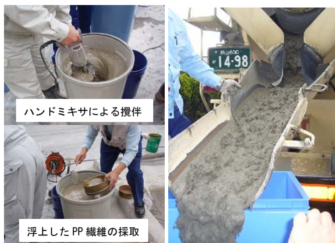
写真-2 洗い試験状況
