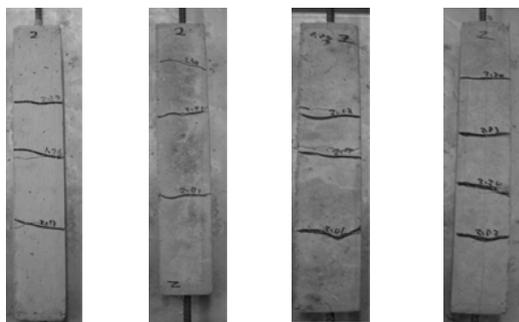
写真 2 D13 供試体写真(左から 0, 0.1, 0.2, 0.3%)
