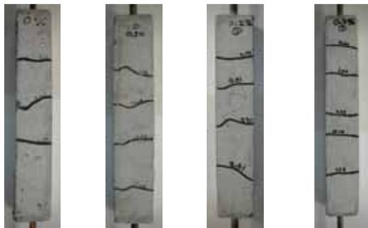
写真 1 D16 供試体写真(左から 0, 0.1, 0.2, 0.3%)
