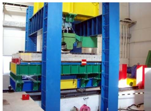
写真-1 輪荷重走行試験装置
