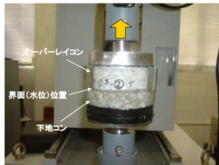
写真-1 水浸引張疲労試験
