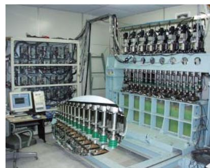
図 3 小型移動荷重載荷試験装置<sup>1)</sup>
