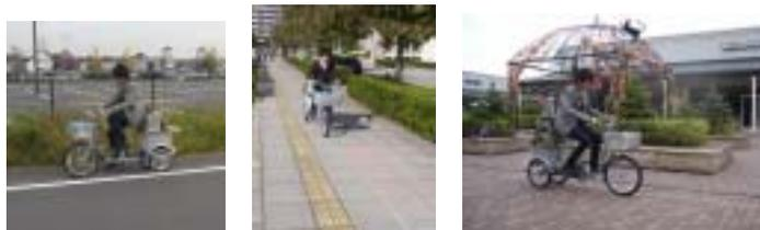
写真-1 各種舗装における自転車の振動測定状況
