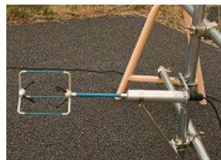
図-1 三次元超音波風速計
