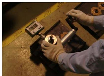
図-6 付着引張試験状況
