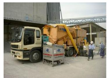
図-2 バッチャーミキサー車
