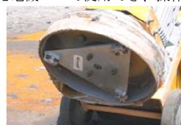
写真-3 床研削機(回転板)
