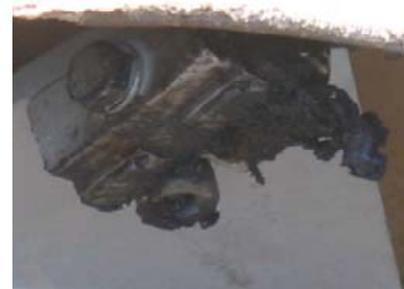
写真-4 研削カッターへの付着
