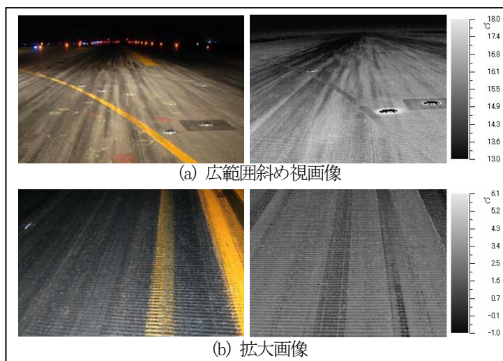
図-1 熱赤外線画像の例(タイヤ痕付着部、滑走路標識部分等)
