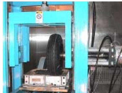
写真-1 カーブホイールトラッキング試験機
