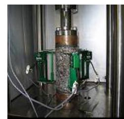
図-1 一軸疲労試験機
