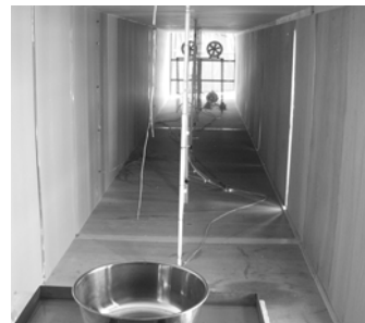
図 2 模型内部の写真(手前:火源,奥:送気ファン)
