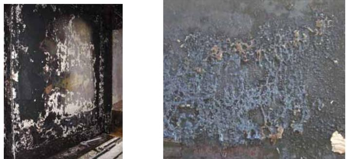
図 - 5 受熱温度毎の塗膜状態
