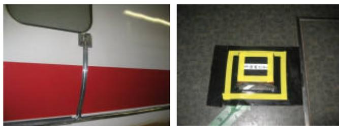
図6 圧力センサー(左)と左右振動加速度センサー(右)
