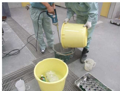
写真-1 モルタル攪拌状況
