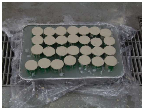
写真-3 低温養生状況
