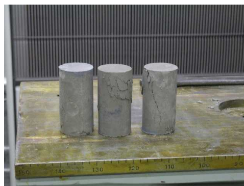
写真-4 試料 1 破壊状況 (1.0h)
