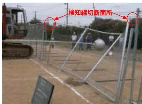
図 4 落石検知部の試験状況（CASE1）
