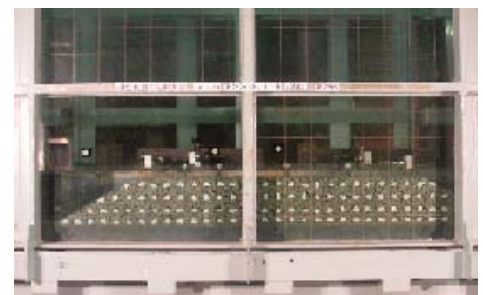
図 3 試験中の模型バラスト軌道
