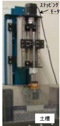
図1 繰返し衝撃載荷試験機
