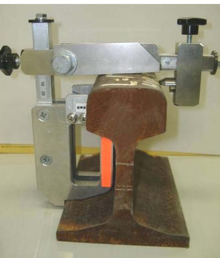
図3 軌道更新用摩耗測定ゲージ
