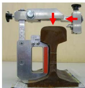
3. 各ゲージを矢印のように動かし、レール頭頂面とゲージコーナーに当てる。
