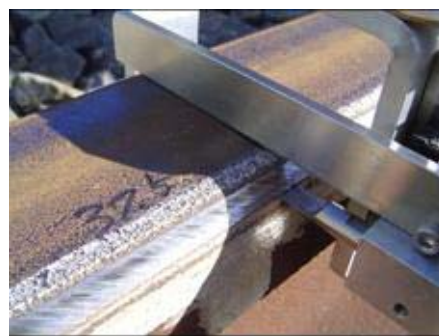
図 1 削正位置の確認 (頭頂面から 5mm 下)
