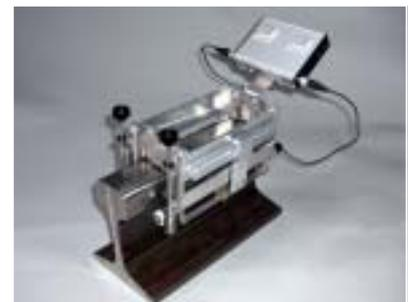
図8 横裂探傷治具
