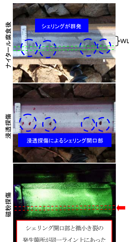
図3 き裂とシェリング開口部の関係
