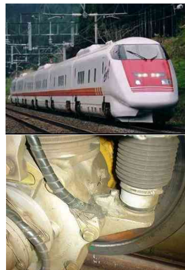
図 7 East-i に搭載された軸箱加速度センサ
