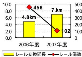
図7 レール交換・レール傷発生状況(前年度比)
