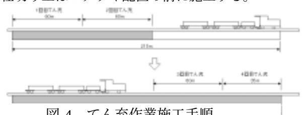
図-4 てん充作業施工手順
