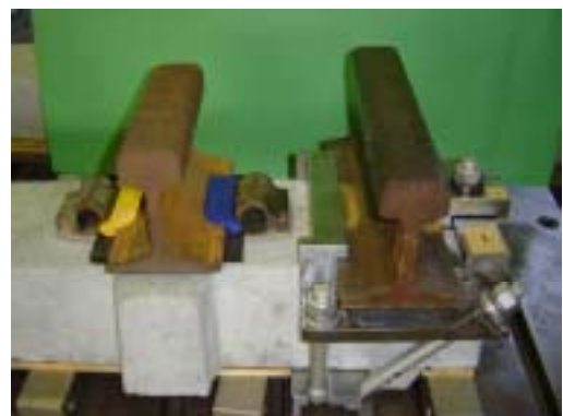
写真-3 安全レール取付金具
