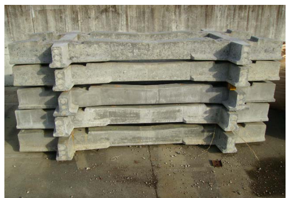
写真-1 載荷試験直後の枠型まくらぎ
