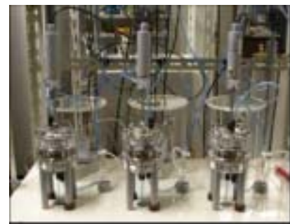
図-1 不飽和透水試験装置
