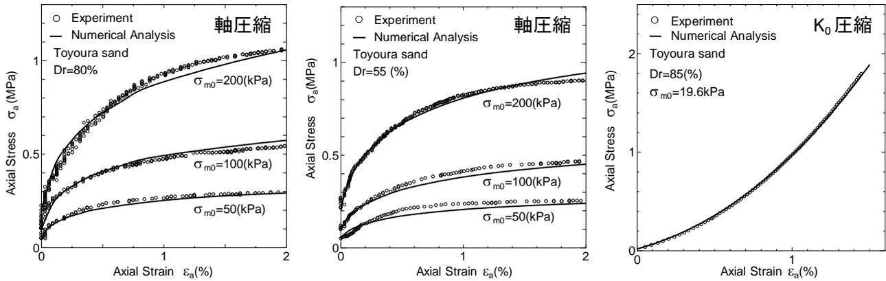
図1 軸応力-軸ひずみ曲線
