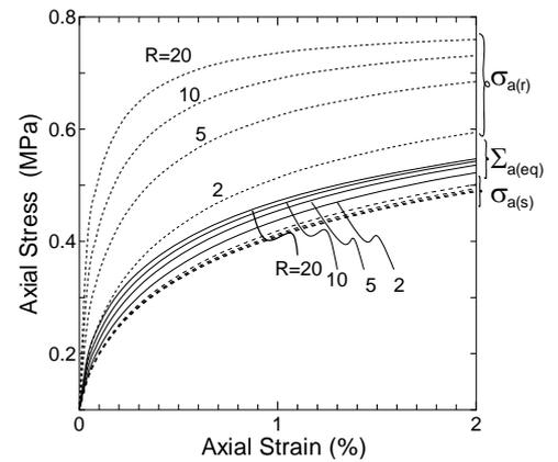
図3 軸応力-軸ひずみ関係
