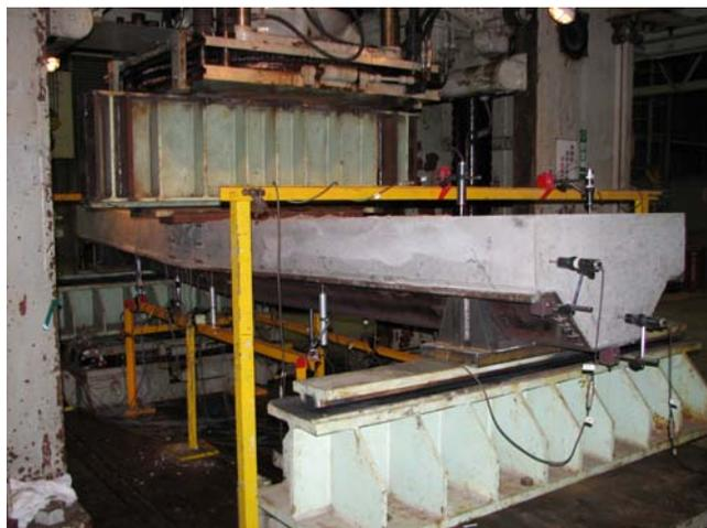
写真1 せん断曲げ試験 B-1 試験体(合成率 0.25)
