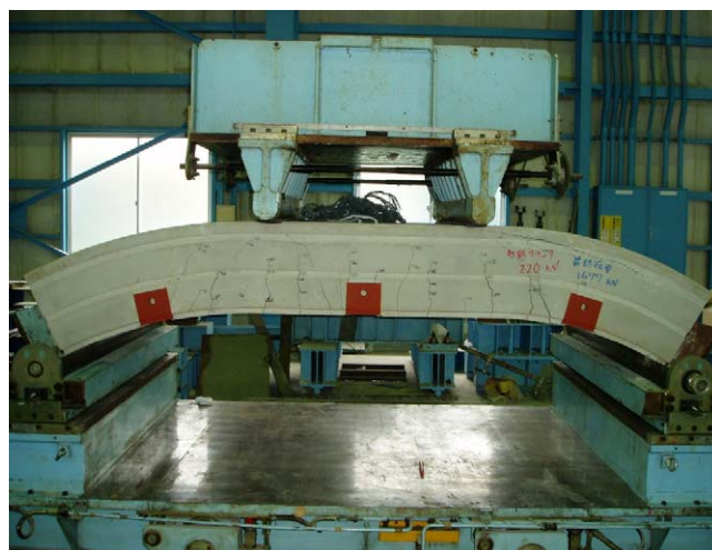
写真-1 単体曲げ試験状況
