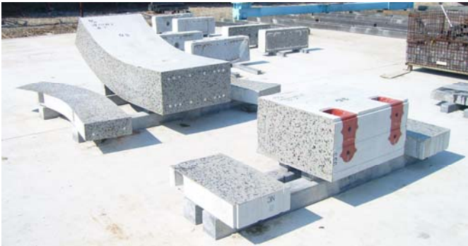
写真-2 切断面の粗骨材分布状況
