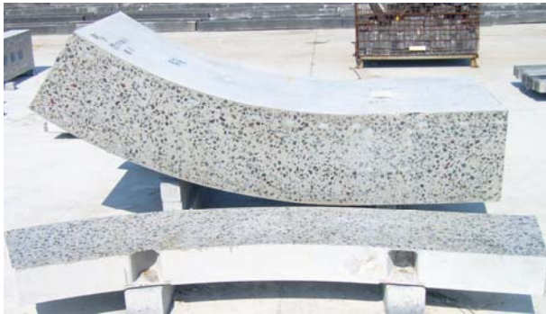
写真-3 切断面の粗骨材分布状況
