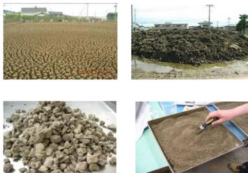
写真-1 浄水汚泥の乾燥過程
