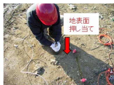
図-3 発振状況 (上: ハンマー打撃、下: 超磁歪型振源)
